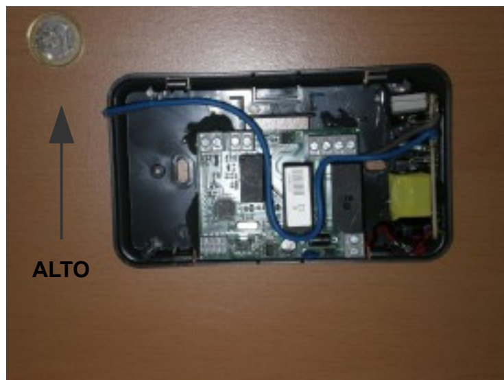
Foto 2: kit assemblato scheda X01 con alimentatore 12V (prodotto aperto)
