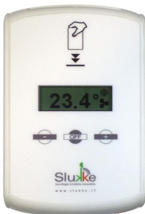
Apparecchio ALL IN ONE: include molte funzionalità degli apparecchi precedenti in un solo apparecchio ovvero la termoregolazione climatica (PIC-MAP), il controllo presenza (PIC-I).
