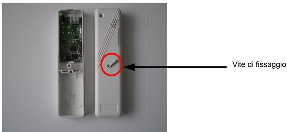
2) Fissare il fondo sull'infisso / porta, usando gli appositi fori di fissaggio.
