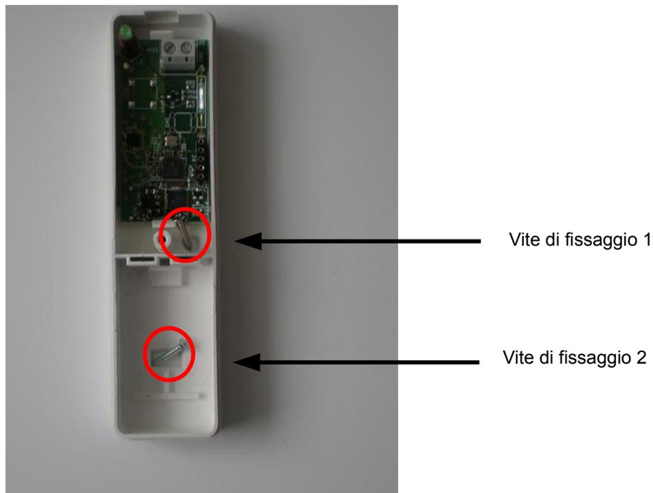
3) Una volta fissato collegare la batteria (già in dotazione) completare chiudere il coperchio.
